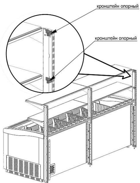
8. При монтаже двухсторонней суперструктуры, смежную витрину придвигнуть спиной, вплотную к суперструктуре. Установить панели перфорированные между стойками.
