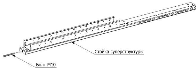
3. Установить стойки суперструктуры по отверстиям, на заднюю спинку ларь-бонеты. Крепить саморезами с прессшайбой 4,2x16 со сверлом.
