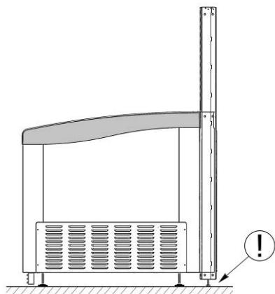
6. Установить кронштейны полок на необходимом уровне. При монтаже двухсторонней суперструктуры, дополнительно устанавливать кронштейны с противоположной стороны стойки.
