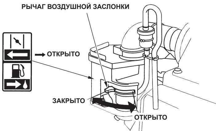
7. Установите рычаг дросселя в положение необходимой частоты оборотов двигателя. Для получения рекомендаций по частоте оборотов двигателя см. инструкции для оборудования, приводимого в действие этим двигателем.
