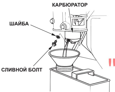
3. После того, как все топливо слито в контейнер, установите на место сливной болт и затяните его сливной гайкой.
