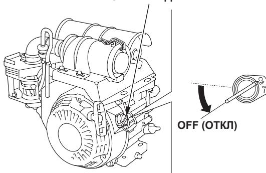
3. Если топливный бак оборудован топливным клапаном или крышкой топливозаливной горловины с воздушным клапаном, поверните их в положение CLOSED или OFF.
