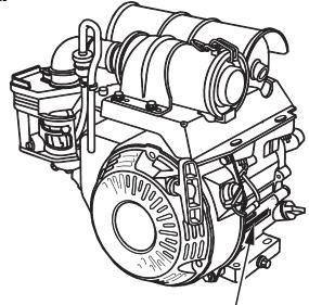
РАСПОЛОЖЕНИЕ СЕРИЙНОГО НОМЕРА И ТИПА ДВИГАТЕЛЯ
